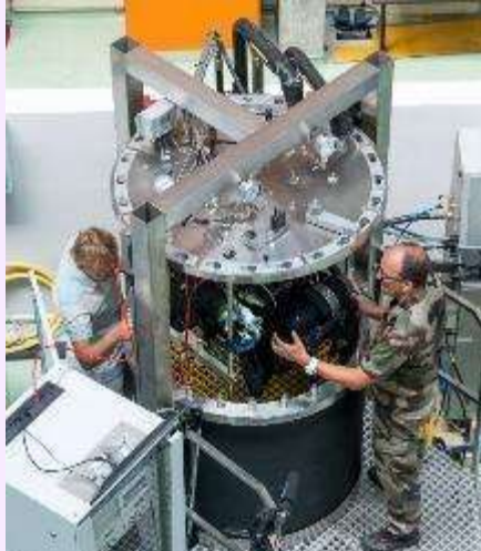
Banc d'essai pour appareils respiratoires en immersion/hyperbarie
